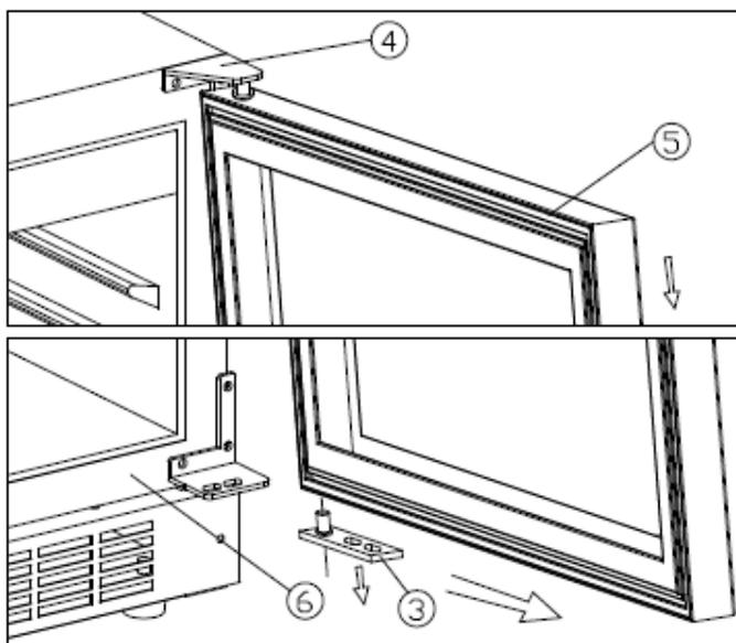
Remova os 3 parafusos de fixação da dobradiça superior direita (4), e remova a dobradiça.
