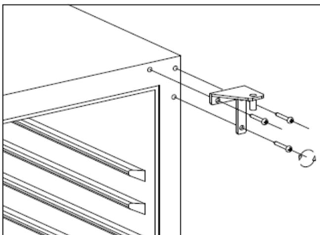
Remova a dobradiça inferior direita (2), removendo seus parafusos de fixação.
